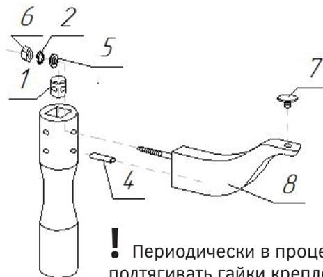
! Периодически в процессе эксплуатации подтягивать гайки крепления лап
